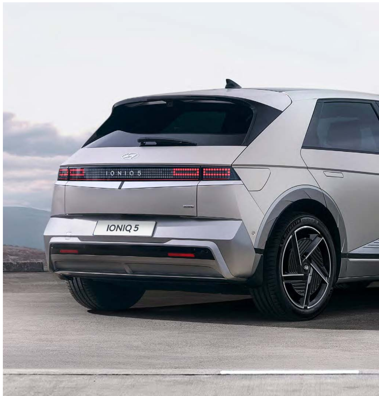
Redizajnirani stražnji odbojnik i vrata prtljažnika / full-LED stražnja kombinirana svjetla
